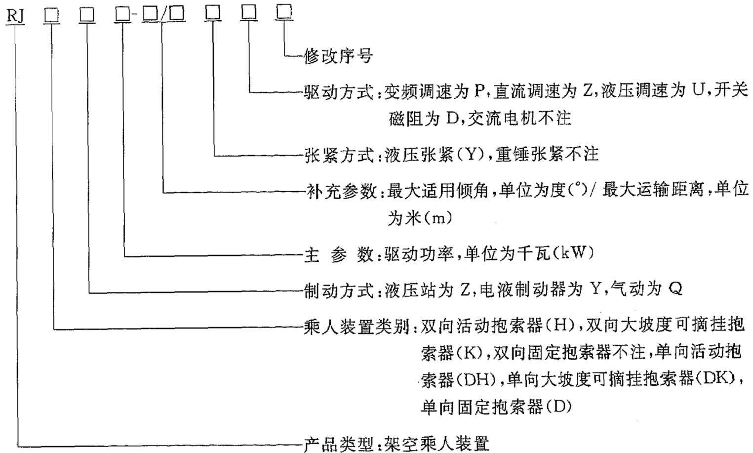
示例 1: 采用液压传动, 液压制动和液压张紧, 最大适用倾角 13°, 最大运输距离 1 600 m, 驱动功率为 45 kW 的活动抱索器架空乘人装置: RJHZ45-13/1600YU;
